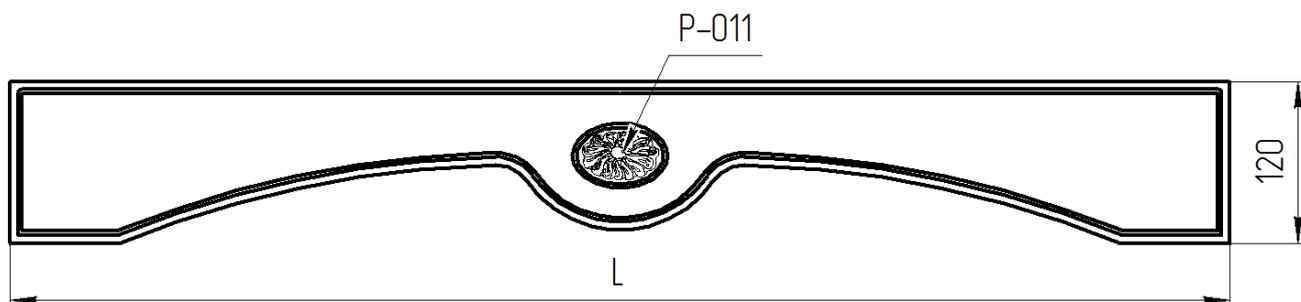
Допустимые размеры для изготовления по ширине  $L = 496...1200$  мм
